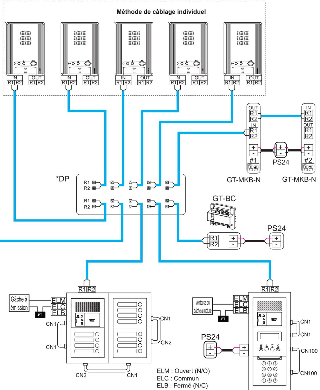
Chaque paire de câbles doit se trouver dans un câble gainé séparément (câblage audio, vidéo et d'alimentation).
